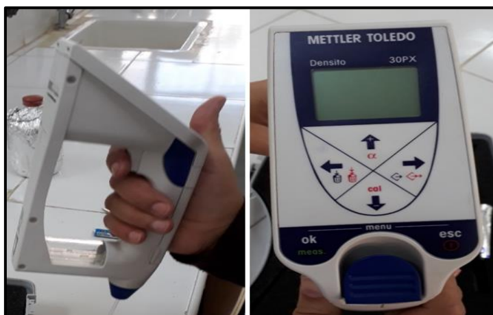
Figure 26 : Mesure de la densité d'huile essentielle d'Ail avec densimètre électronique.
