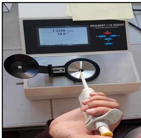
Figure 24 : Mesure de l'indice de réfraction de l'huile essentielle d'Ail.
